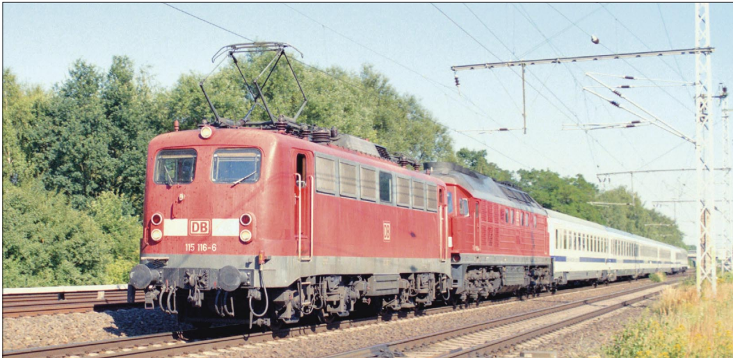
Bild 6 Zur Stabilisierung der Stromversorgung im Bistrowagen liefen zeitweise Lokomotiven der BR 115 im Zugverband mit. Im Sommer 2006 ist die 115 116 als Vorspannlok im Einsatz.
