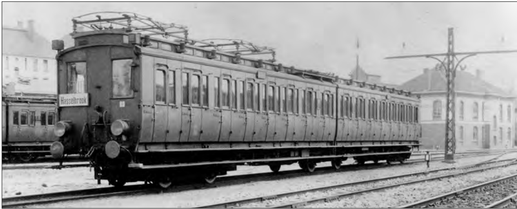
Bild 5 Elektrischer Triebzug für Oberleitungs-betrieb mit Einphasen-Wechselstrom in Hamburg im Jahr 1906. Dieses Jahr gilt als Entstehungsjahr der Hamburger S-Bahn.
