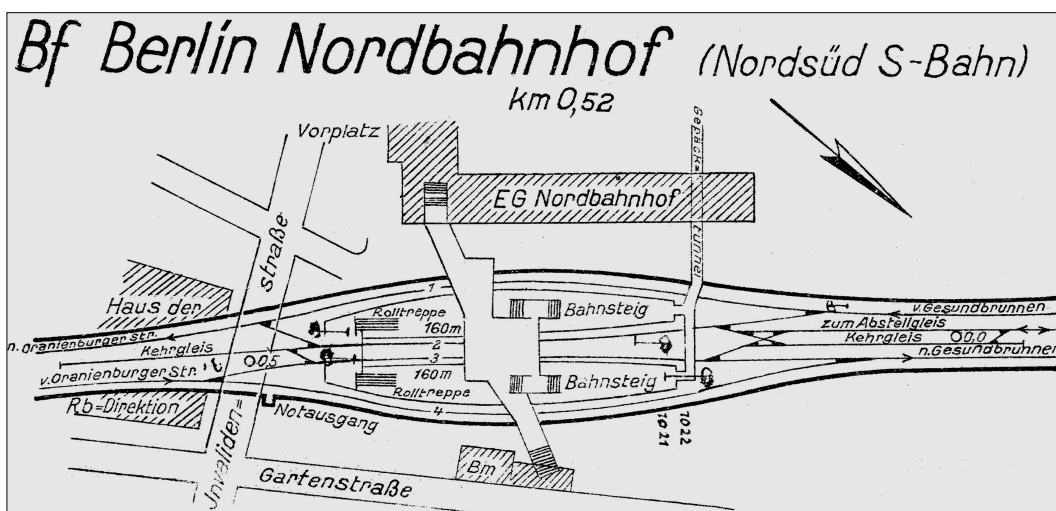
Bild 5 Lageplan des unterirdischen S-Bahnhofs Nordbahnhof von 1962 (Zeichnung Sammlung Bernd Kuhlmann)
