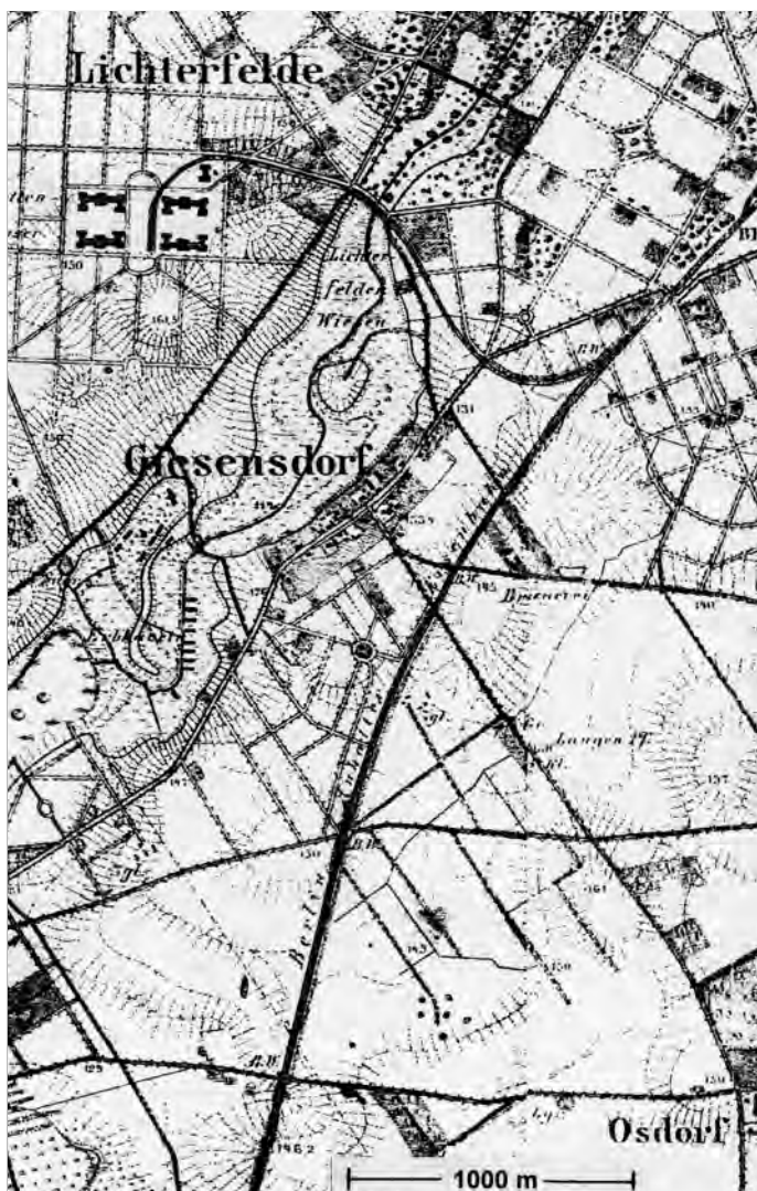
Bild 2 Der Kartenausschnitt zeigt die Anhaltische Bahn im Bereich Lichterfelde/Giesensdorf im Jahre 1874. Gut erkennbar ist das Anschlussgleis zur Hauptkadettenanstalt, das Siemens später für die elektrische Bahn nutzte. (Sammlung Peter Bley)
