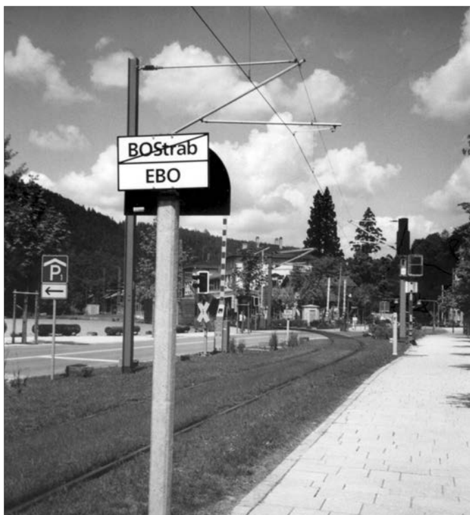
Bilder 2 und 3 Der Triebwagenführer wird jeweils durch Hinweisschilder und das Ausschaltzeichen auf den Systemwechsel aufmerksam gemacht. (Fotos Lutz Habrecht)
