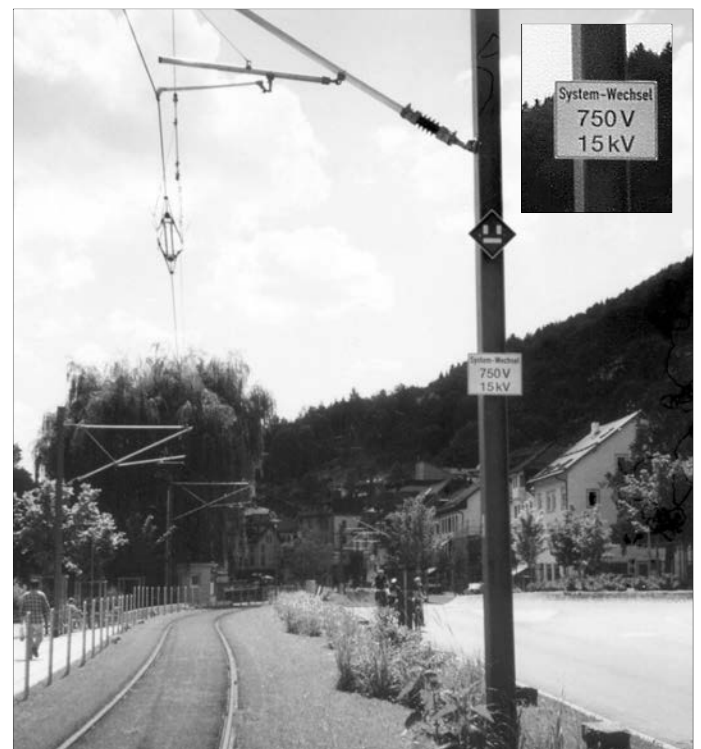
Bilder 2 und 3 Der Triebwagenführer wird jeweils durch Hinweisschilder und das Ausschaltzeichen auf den Systemwechsel aufmerksam gemacht. (Fotos Lutz Habrecht)
