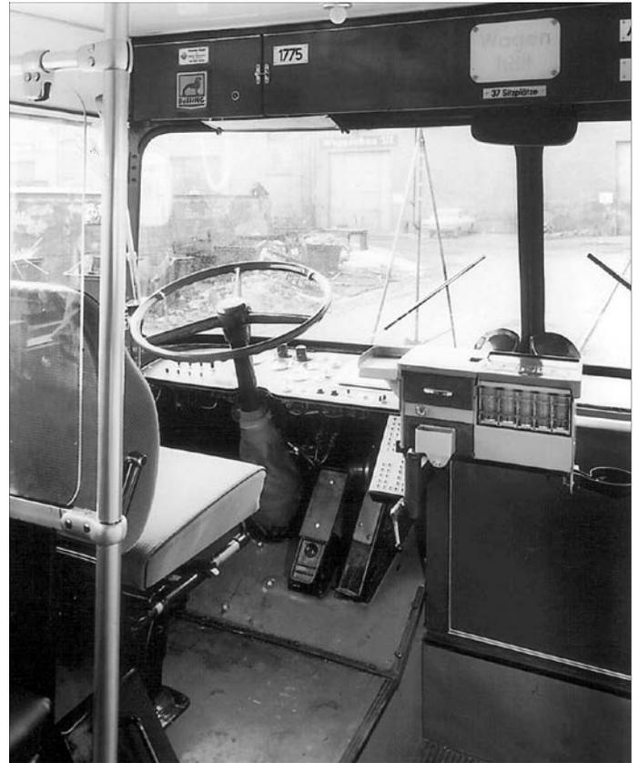
**Bild 2 Fahrerplatz des Wagen 1775 mit dem Leuchttabelleau für die Sitzbelegung des Oberdecks links unterhalb des zurückgeklappten Kassentisches**
